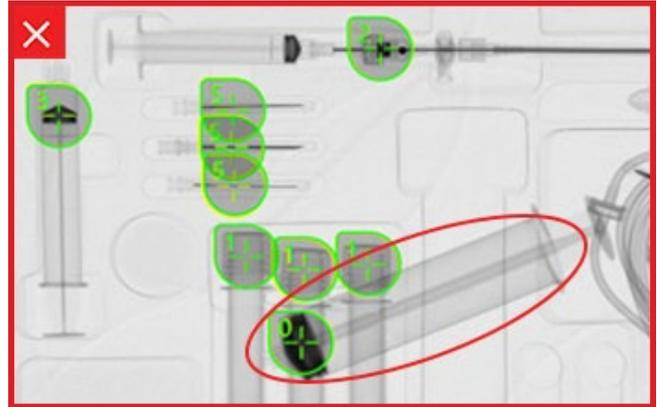
在发货前,您可以使用深度学习X射线检测系统检查由多个元件组成的有包装的医疗和药品工具包的完整性和损坏情况。
