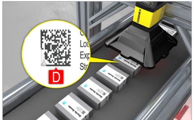
生产线上的条码验证器可以按质量分级医疗器械包装上的标签码, 确保其符合质量标准。
