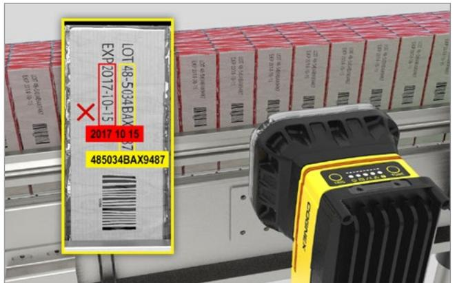
使用光学字符识别技术的机器视觉系统可靠地读取生产链中的字母数字日期/批号条码。
