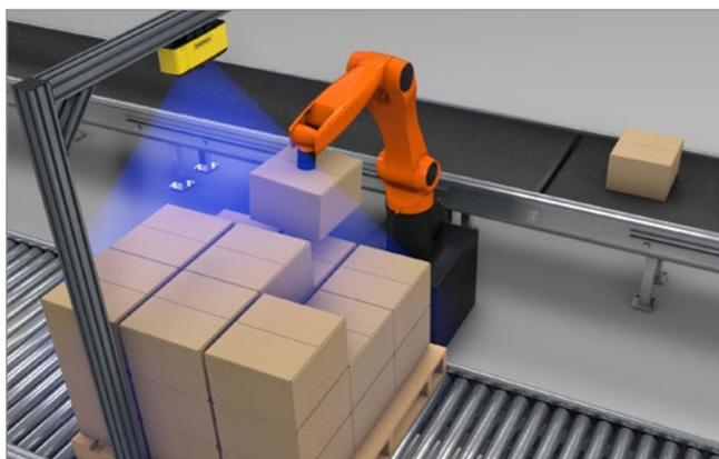
视觉向导机器人将包装箱装货盘发货,可减少产品的手工处理和污染风险。
