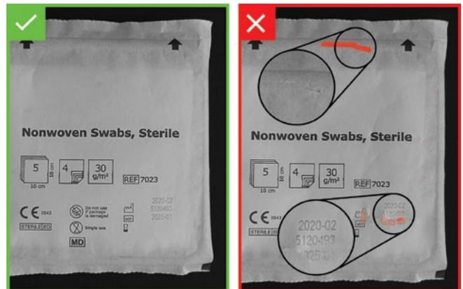
深度学习图像分析软件可以探测包装缺陷、标签中的气泡、撕裂的标签,以及可能导致设备混淆或报废的其他包装完整性和表面缺陷。
