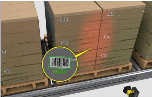
借助大景深和宽视野，康耐视读码器可以同时读取货盘上的多个条码。
