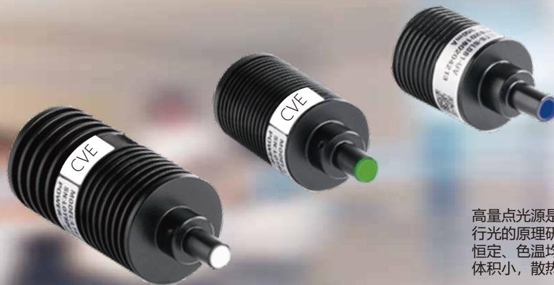
高量点光源是利用大功率LED通过光学透镜聚焦后发出平行光的原理研制而成的,与传统的光纤卤素灯相比具有亮度恒定、色温均匀、使用寿命长等特点。顶端直径为8mm,体积小,散热性能好。
