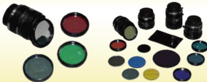
工业相机的光谱灵敏区域一般在400-700nm可见光，感应最灵敏的位置，一般是红光。（见图1）整个感光范围可包括：紫外、可见光和近红外波长。根据工业相机的感光度范围及照明条件，常用机器视觉滤光片一般包括紫外线（UV），可见光和近红外（NIR）的部分波长。根据波长分类，可分为：紫外滤光片、可见光滤光片、近红外滤光片。根据过滤类型，可分为短波通滤光片、长波通滤光片、窄带滤光片等。
