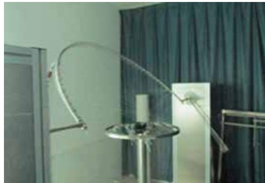
测试条件：在专业的喷洒器，光源到水面距离为：800MM，测试时间为12小时。
