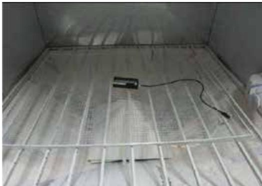
测试条件：在专业的灰尘箱中，不断的灰尘漂落到产品上，时间测试为12小时。
