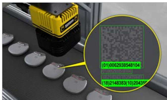
代码读取和 OCR: 同时读取二维码和文本
