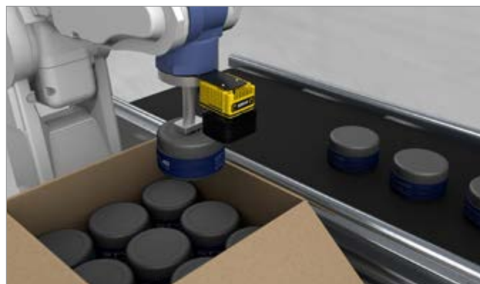
机器人引导: 分拣成品并将其放入箱中
